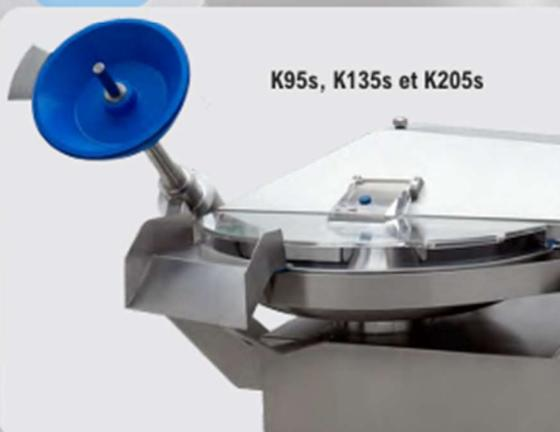
**Bras de déchargement manuel avec disque extracteur motorisé à vitesse variable 50-150 tr/min.**
