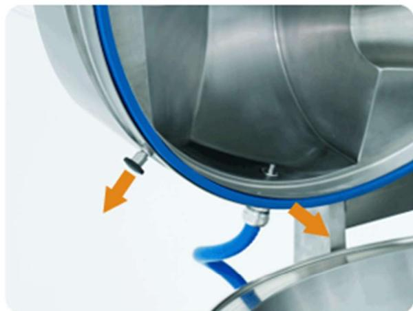
Joint couvercle-cuve démontable, autoréglable par ressorts.
