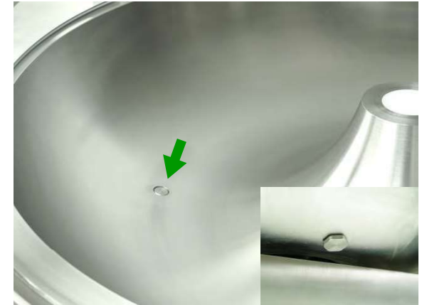
Cuve avec système de vidange .
