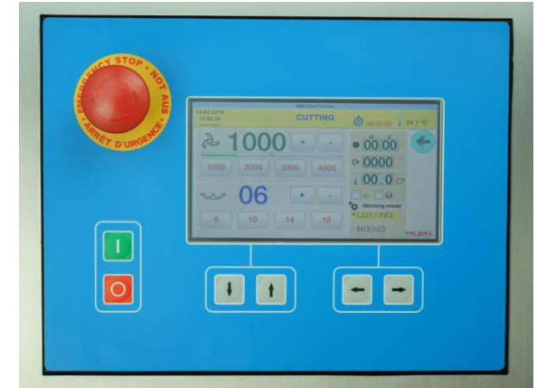
Écran numérique de contrôle et de programmation pour toutes les fonctions de la cutter.
