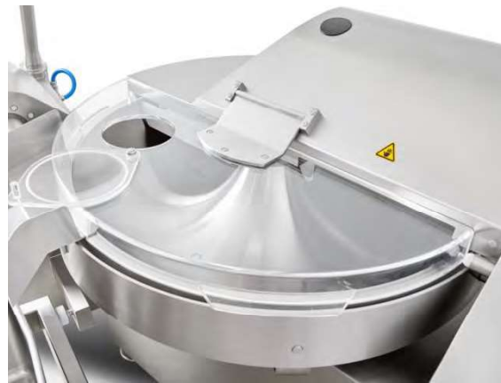
Couvercle anti-bruit rabattable avec ralentissement automatique de la vitesse des couteaux - pourvu d'une ouverture pour l'addition d'épices sans nécessité d'ouvrir le couvercle. (K200)
