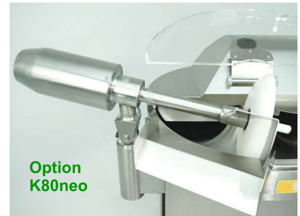
Bras déchargeur motorisé pour vidange simple et rapide de la cuve.
