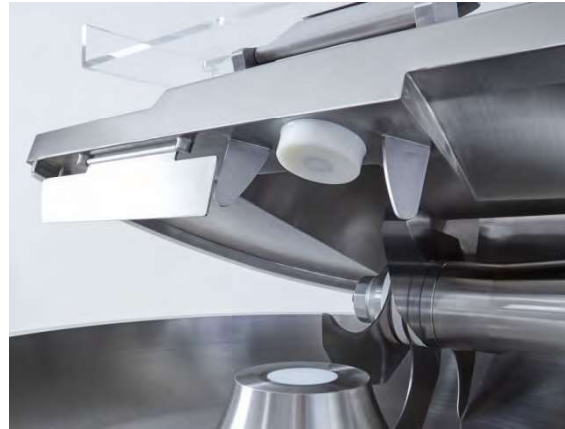
Surfaces polies, aucun coin rayon CÉ pour un nettoyage facile.
