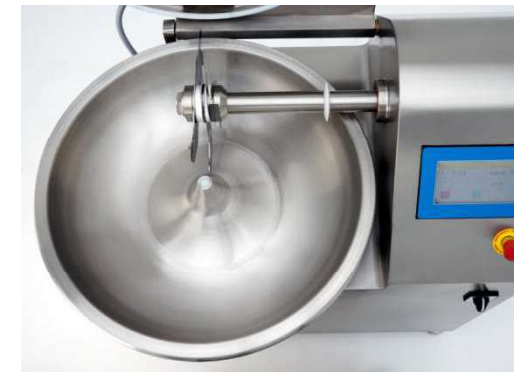
Cuve en fonte d'acier inoxydable massif. Usinage CNC.
