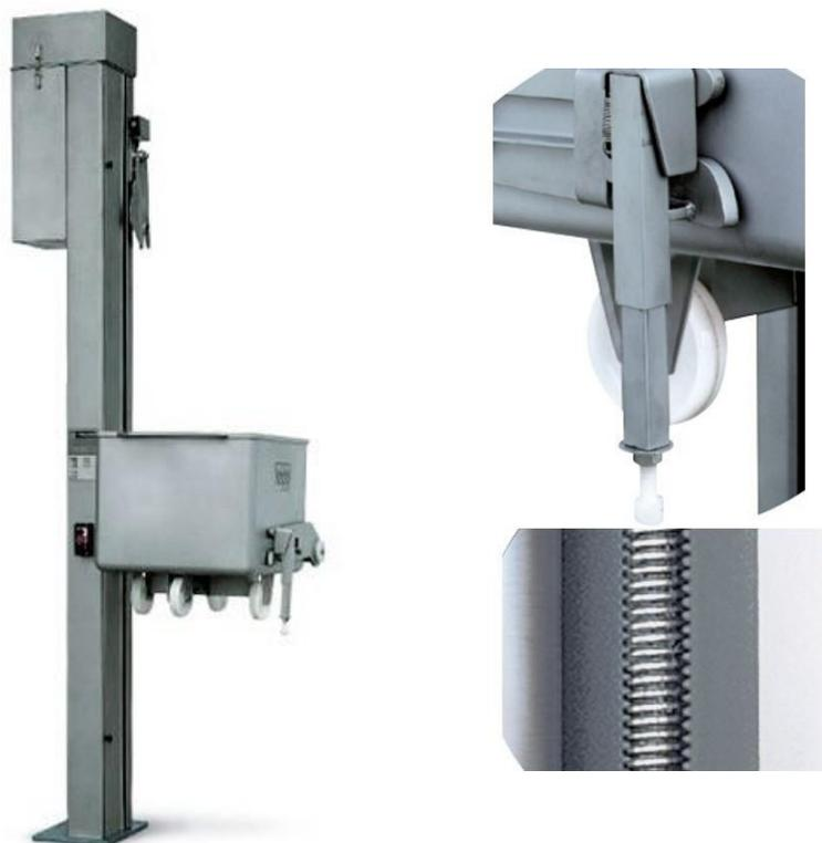
Élévateur-chargeur à colonne construit en acier inoxydable avec une conception solide et robuste. Transmission par vis sans fin, supportée par des roulements axiaux et radiaux. Ecrous de levage équipés d'un système de sécurité qui empêche la chute du chariot. Possibilité de régler la hauteur de déchargement, en fonction de la machine à alimenter.
