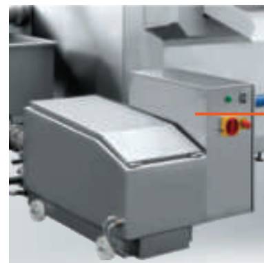
Emulsifier for grinding the return brine Emulsificador para triturar la salmuera de retorno
