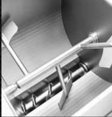
**¡La calidad de sus productos es importante para nosotros!** Por lo tanto, las mezcladoras Kolbe Foodtec están equipadas con una función de autoreversa. Durante el proceso de mezcla, esta función asegura una mezcla uniforme de la carne a procesar y, por lo tanto, un procesamiento uniforme y un resultado homogéneo de la carne picada. El brazo mezclador gira alternativamente cuatro veces a la izquierda, cuatro veces a la
