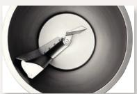
La cuve peut être inclinée à différents degrés. Le large diamètre de la cuve permet de bien faire rouler son contenu. Grâce à une fréquence de rotation réglable de 0 à 25 tours / min, les bras mélangeurs peuvent remplir une quantité infinie de fonctions. Un système de deux bras mélangeurs travaille les aliments en douceur, de manière homogène et sans espaces mortes.
