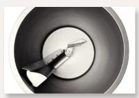
La cuve peut être inclinée à différents degrés. Le large diamètre de la cuve permet de bien faire rouler son contenu. Grâce à une fréquence de rotation réglable de 0 à 25 tours / min, les bras mélangeurs peuvent remplir une quantité infinie de fonctions. Un système de deux bras mélangeurs travaille les aliments en douceur, de manière homogène et sans espaces mortes.
