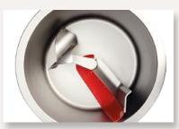
La cuve peut être inclinée à différents degrés. Le large diamètre de la cuve permet de bien faire rouler son contenu. Grâce à une fréquence de rotation réglable de 0 à 30 tours / min, les bras mélangeurs peuvent remplir différentes fonctions. Le reste est pris en charge par un bras sans coins ni arêtes muni d'une grande surface de prise.
