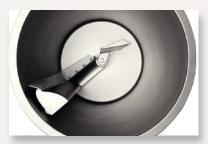
La cuve peut être inclinée à différents degrés. Le large diamètre de la cuve permet de bien faire rouler son contenu. Grâce à une fréquence de rotation réglable de 0 à 16 tours / min, les bras mélangeurs peuvent remplir une quantité infinie de fonctions. Un système de deux bras mélangeurs travaille les aliments en douceur, de manière homogène et sans espaces mortes.
