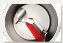
La cuve peut être inclinée à différents degrés. Le large diamètre de la cuve permet de bien faire rouler son contenu. Grâce à une fréquence de rotation réglable de 0 à 30 tours / min, les bras mélangeurs peuvent remplir différentes fonctions. Le reste est pris en charge par un bras sans coins ni arêtes muni d'une grande surface de prise.
