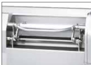
La fermeture de la trappe s'effectue en toute simplicité grâce à son mouvement radial. C'est uniquement ce mouvement qui permet l'utilisation pratique à une seule main et la chambre est remplie jusqu'au niveau maximum.
